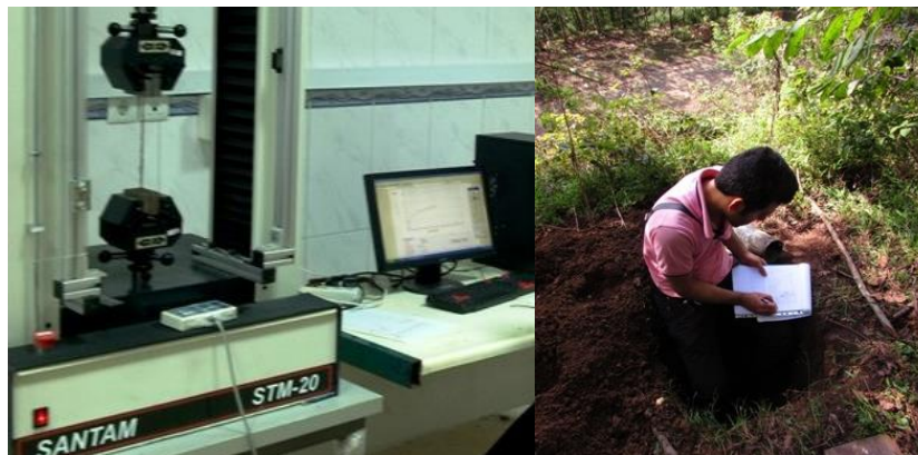
شکل ۱- نمونه‌برداری ریشه و تعیین مقاومت کششی با استفاده از دستگاه سنتام Figure 1. Root sampling and determination of tensile strength using the Santam device
