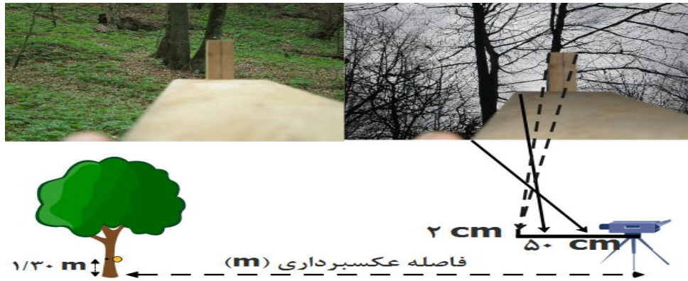
شکل ۲- الگوی از نحوه قرارگیری دوربین و شاخص به همراه دو نمونه از تصاویر تهیه شده از درختان Figure 2. Schematic position of the camera and indicator, along with two examples of images taken from trees
