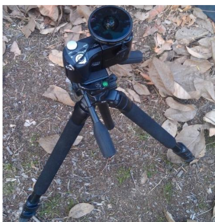
شکل ۳- دوربین مجهز به عدسی چشم‌ماهی (Nikon Coolpix with 180° fish-eye lens) Figure 3. Fish-eye lens (Nikon Coolpix with 180° fish-eye lens)
