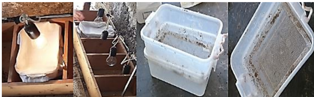
شکل ۲- قیف برلیز طراحی شده برای جداسازی پادمان از خاک و لاشبرگ (اصلی) Figure 2. Berlese funnel designed to extract the Collembola from soil and litter (Original)
