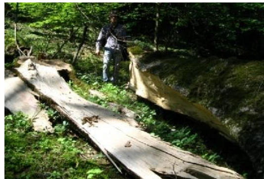
شکل ۲- افت چوب به صورت جدا شدگی ورقه‌ای
