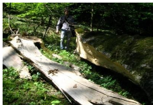
شکل ۲- افت چوب به صورت جدا شدگی ورقه‌ای
