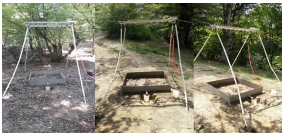
شکل ۲- استقرار شبیه‌ساز باران در جنگل (شکل راست)، رد چرخ (شکل وسط) و مرکز مسیر چوب‌کشی (شکل چپ) Figure 2. Installation of the rain simulator in the forest (right picture), wheel track (middle picture), and the center of the skid trail (left picture)
