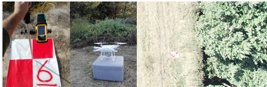
شکل ۲- نقطه کنترل زمینی در عرصه (چپ) و برداشت همان نقطه کنترل زمینی با DGPS (راست)
